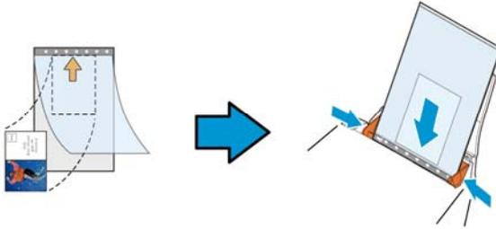
2. Cargue la hoja portadora con la sección gris (sección impresa) hacia abajo.
